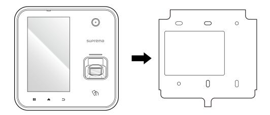
**3** BioStation A2의 제품 고정용 나사를 돌려 BioStation A2와 브래킷을 조립하세요.
