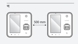
• 모바일 출입카드를 사용할 경우 BLE 신호 간섭을 피하기 위해 장치 사이에 최소 1 m 이상의 거리를 두고 설치하세요.
